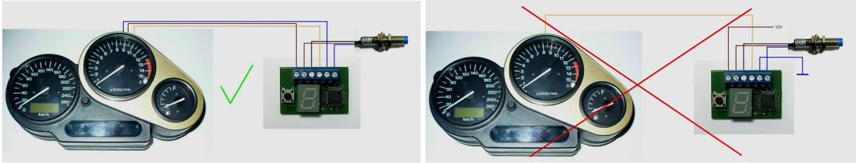
Bei vielen Motorrädern wird das Tachosignal im Kabelbaum auch parallel zum Motorsteuergerät geführt. Auch deshalb sollte möglichst der originale Kabelbaum verwendet werden.
