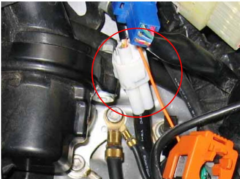
Geschwindigkeitssensor, Signal abnehmen an Steckverbindung (Speedo bei Acumen // **Oranges** Kabel anschliessen ). Kabelfarbe im Kabelbaum → Weiss-Gelb.
