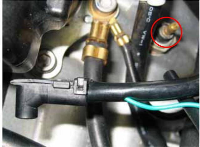
Das abnehmen des Signals für den Leerlauf geht am besten direkt am Leerlaufschalter. (siehe roter Kreis ) Kabelfarbe im Kabelbaum → **Hellblau**
